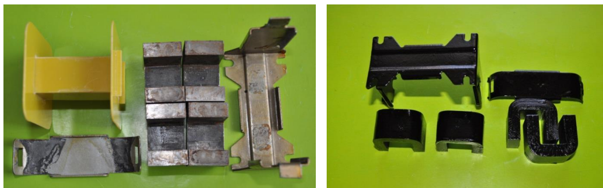
рис.10 Комплект железа подготовлен к покраске. Катушка новая.
