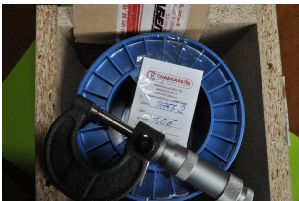
рис.13 Уточняется диаметр провода, на протяжении 20 м диаметр по изоляции от 1,08 до 1,13 мм (бывало и хуже). Если этого предварительно не делать, то витки могут не поместиться.
