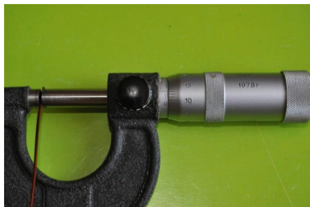
рис.13 Уточняется диаметр провода, на протяжении 20 м диаметр по изоляции от 1,08 до 1,13 мм (бывало и хуже). Если этого предварительно не делать, то витки могут не поместиться.
