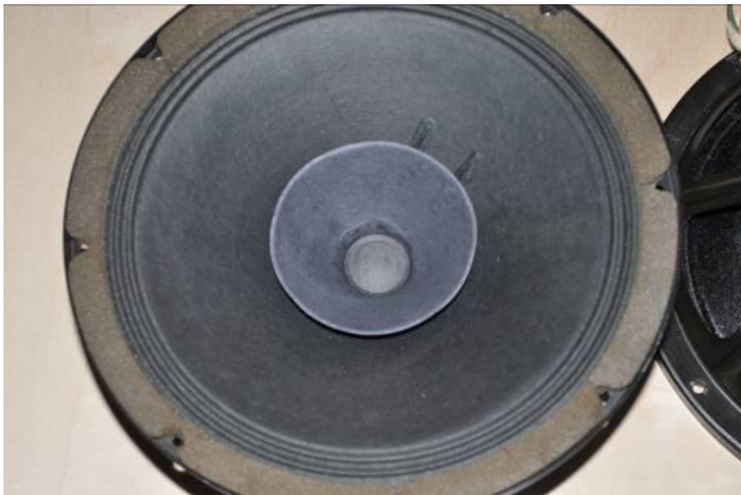
рис.2 Philips AD 1065/M8. Ободок из пенопласта болотного цвета, задубевший и понемногу крошится. Наружный диаметр корзины 261 мм, внутренний (посадочное место) 231 мм, и толщина обода 9 мм.
